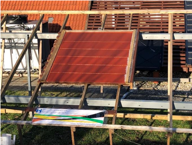
Figur 1.5.5. Foto fra Demosite opbygning med Røde solceller på Teknologisk Institut. Her ser at der ofte er skygge når der skal laves målinger i januar måned.
