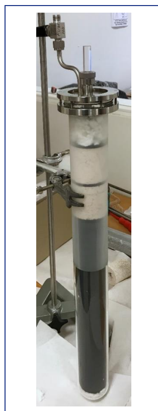
Figur 8.3: Digel med AlSi12 og omsluttende kvartsrør.
