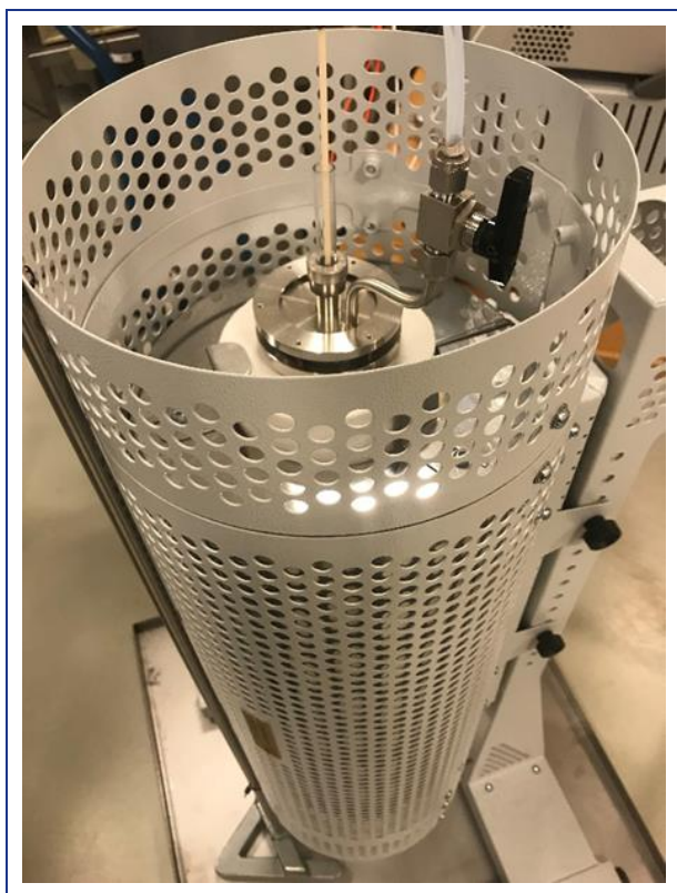
Figur 4.2: Foto af testovnen med smeltecellen. I midten ses et kvartsrør med termoføler og tilslutning til argon-beskyttelsesgas. Selve smeltecellen med det faseskiftende materiale (AlSi12) er ikke synlig.
