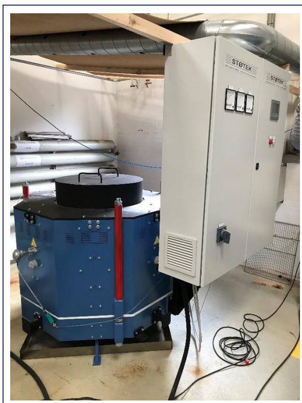
Figur 4.7: Specialovnen fra Støtek til smeltforsøg.
