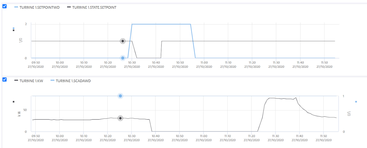
Figur 18: Setpunkt og energiproduktion forbundet med vandturbinen.
