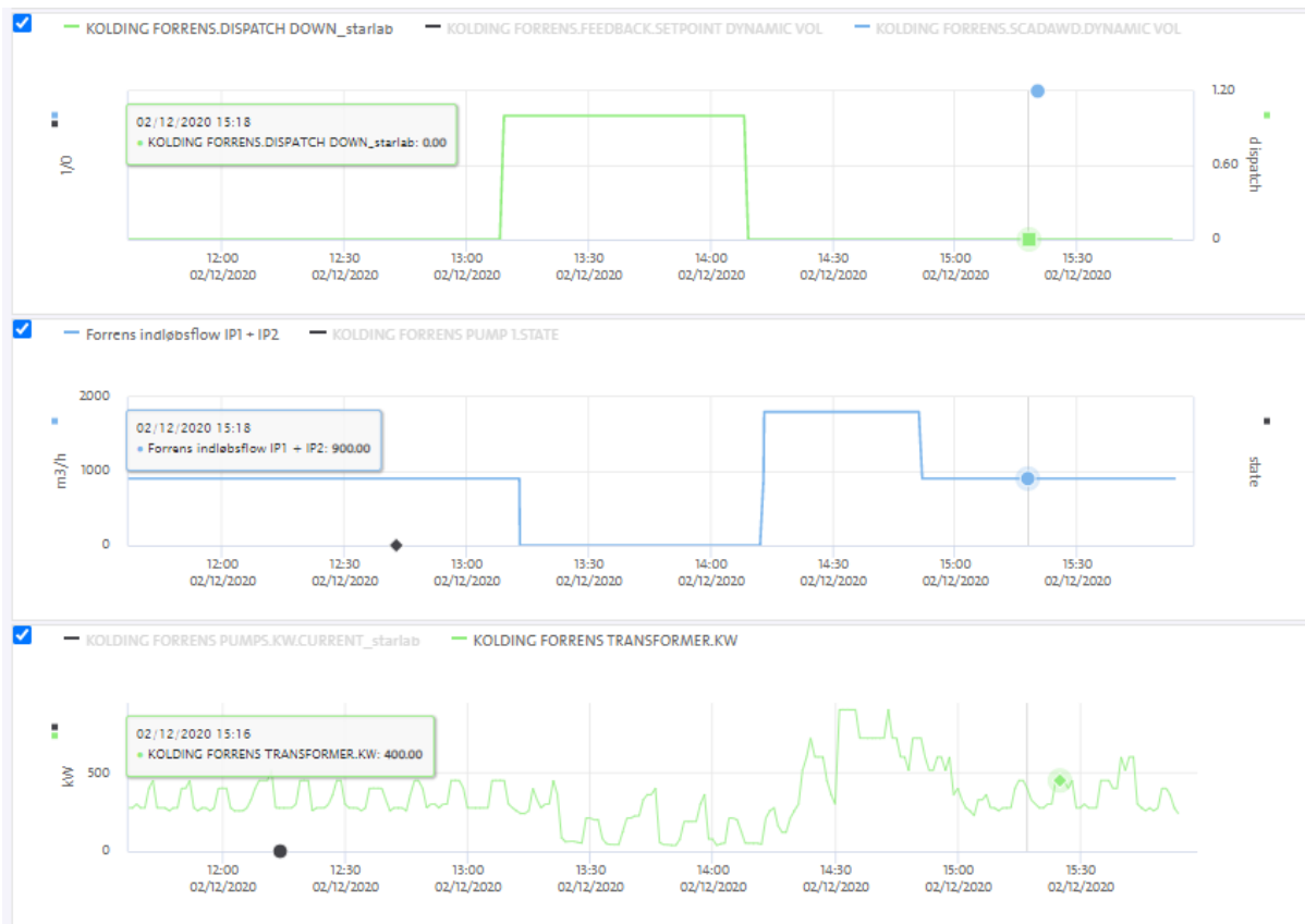
Figur 12. Eksempel på pumpedrift under en anmodning fra Energi Danmark om at sænke energiforbruget.
