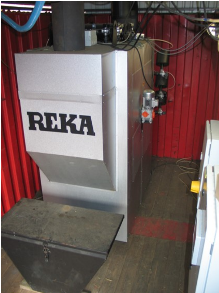
Figur 2: Container med forsøgsanlæg opstillet ved AU Foulums biomassefyrlaboratorium. Anlægget består af Alcon halmkedel og første udgave af elektrofilteret.
