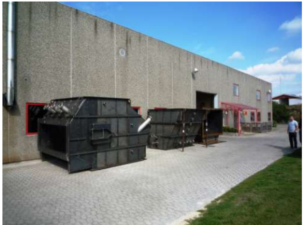
Figur 3.1 Ovn elementer hos Refcon til udmuring. Til højre: Morten Andersen fra SEM stålindustri
