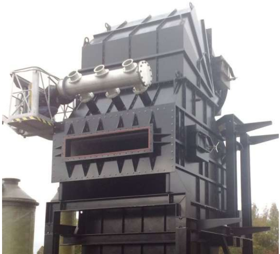
Figur 3.4 Montage af dyser til sekundær luft.
