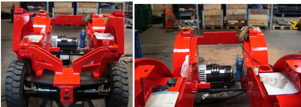
Billede 29: Dantruck 3000 Power Hydrogen under opbygning
