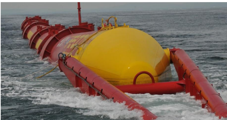
Figur 19 Pelamis 2 under bugsering mod EMEC-testsitet ved Orkney [ W32 ].
