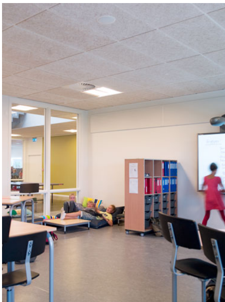
Figur 18. Komfortventilation med systemløsning baseret på en nedhængt loftsflade med aktive og passive ventilationsplader. Billedet til venstre er fra Lisbjerg skole i Århus.
