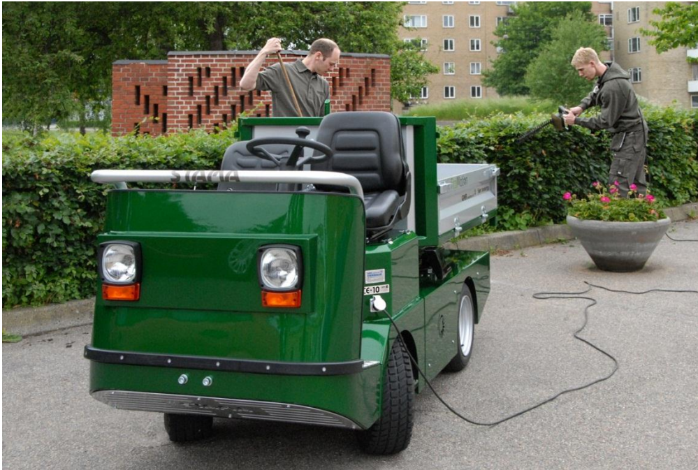
Figur 1: Ecomotion prototype multitruck i brug som forsyning til hækklipper og til hækaffald
