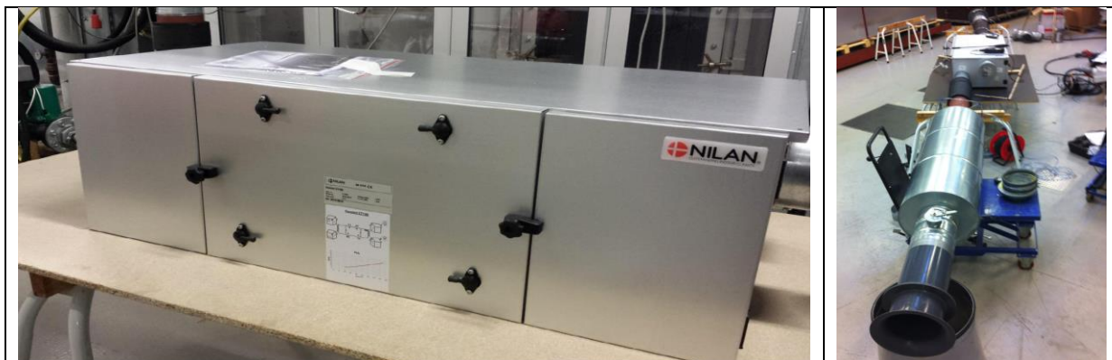
Foto af ventilationsaggregat og billede af lydmåling til højre.
