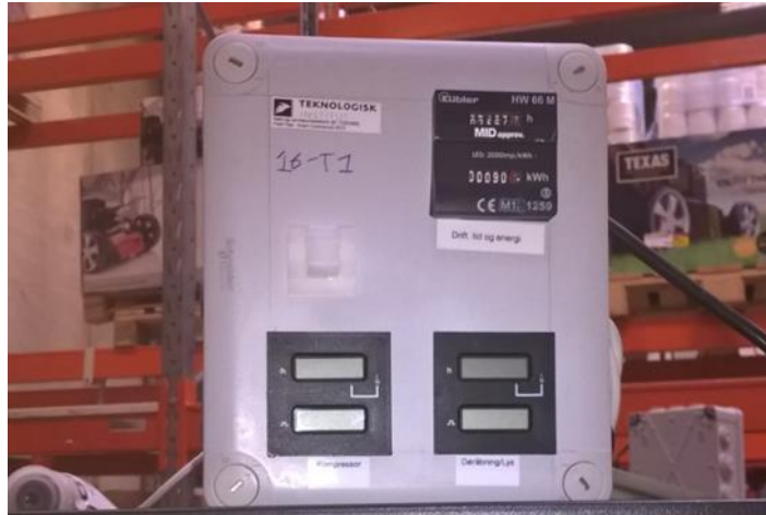
Foto 4: Foto af målekasse og den ene temperaturlogger, placeret ovenpå en flaskekøler.
