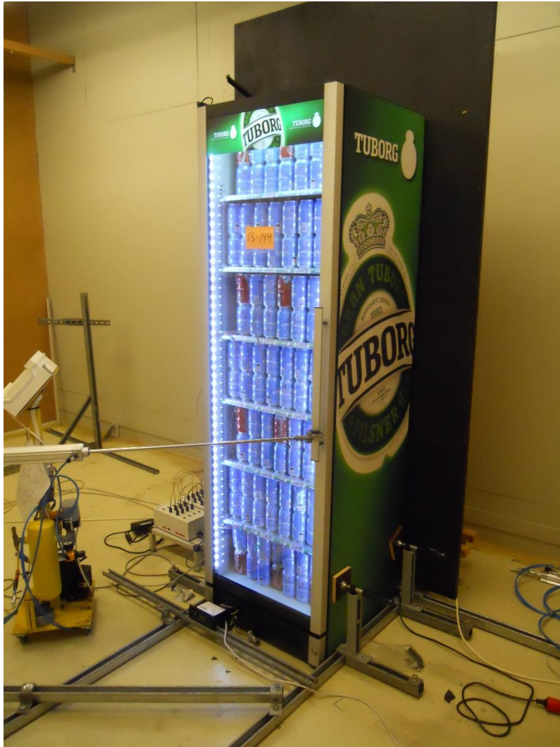
Foto 1: Vestfrosts M200 flaskekøler under test i laboratorium på Teknologisk Institut. Her er den fyldt med 504 dåser mineralvand. Der står tusindvis af disse rundt om i danske supermarkeder og kiosker, ofte "labelled" med Coca-Cola, Tuborg eller Carlsberg. Størstedelen af Vestfrosts produktion bliver dog eksporteret til bl.a. Coca-Cola og globale bryggerier.
