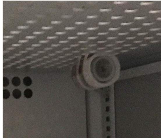
Figur 7 Tinytag stripset til undersiden af midterste hylde
