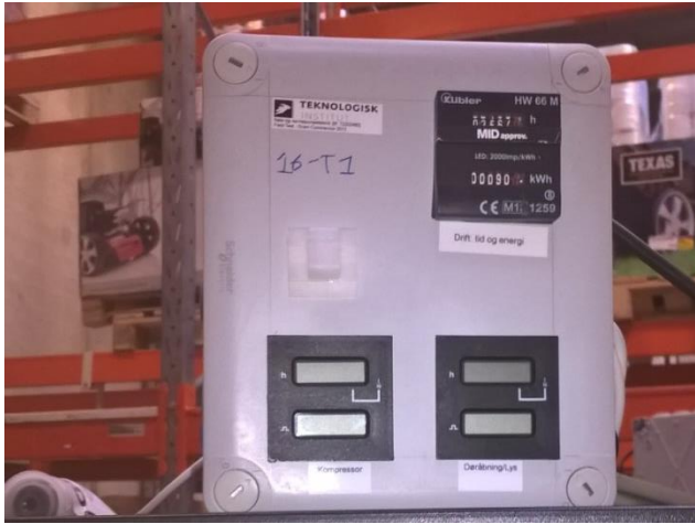
Figur 6 Måleboks og Tinytag placeret oven på hver flaskekøler
