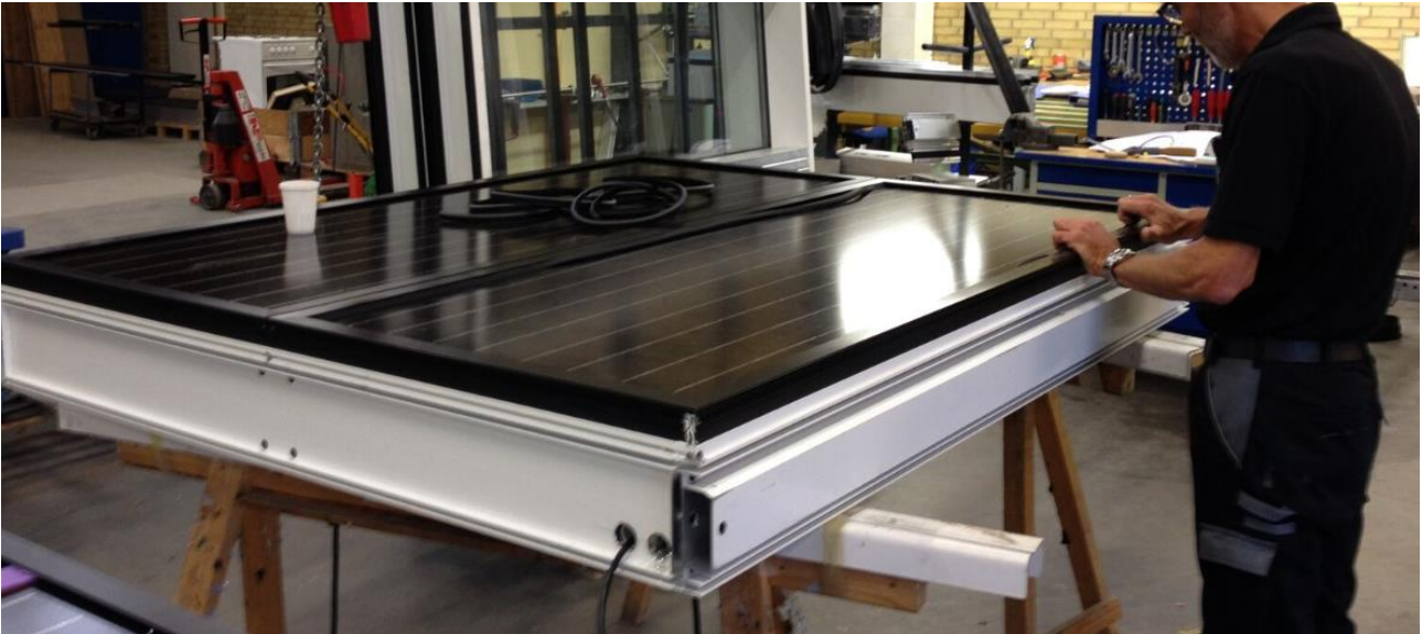
Isætning af solcellepaneler med specialdesignede lister og låsegummi.
