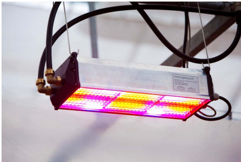
Figur 1: Prototype III armaturet under test. Kølevandtilslutningen ses i venstre side af armaturet.
