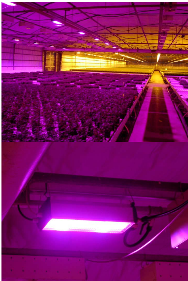
Figur 15: Billede af forsøgssopstilling hos RosaDanica. Bemærk farveforskellen på det venstre billede mellem det nye lys og det traditionelle gule lys i baggrunden.
