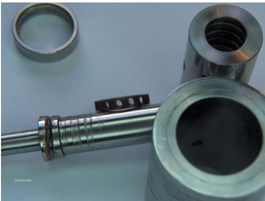
Fig. 5.2.1.1 Billede af smadret keramiske leje efter få timers kørsel
