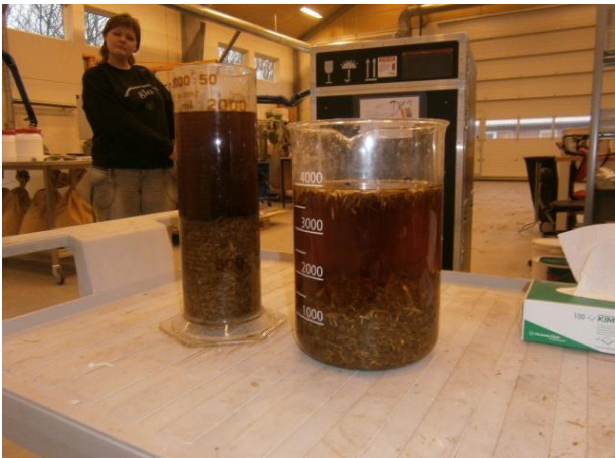
Billederne viser, hvorledes forarbejdet halm suger vand og synker ned i vandsøjlen.
