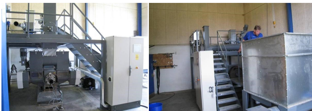
Prototypeopstilling med presse, styretavle, silo til snittet halm mv.
