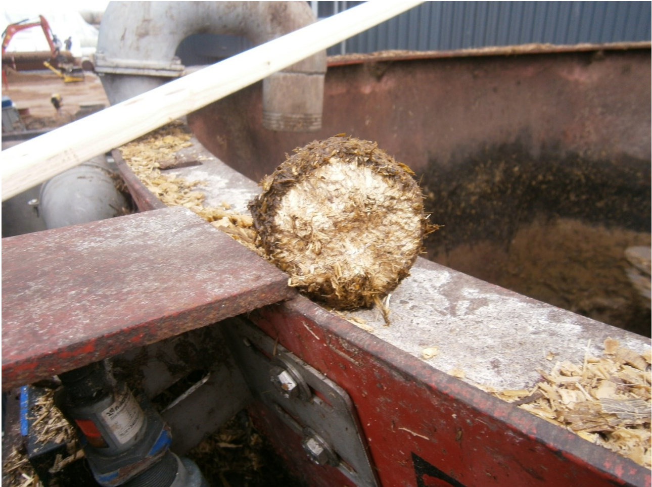
Billedet viser indtrængende gyllevæske i ubrudt halmbrikette.
