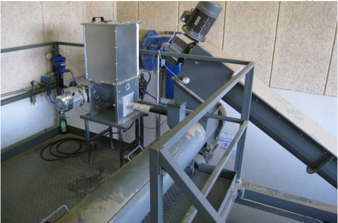
Mikser og beholder til pulvere på anvendt prototype.
