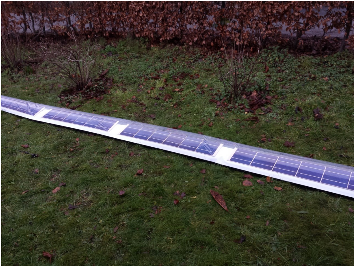
Figur 3. Tredje generation prototype. Denne prototype var den første, med mere end to celleplader og dermed den første, hvor foldninger af begge typer (celle-mod-celle og ryg-mod-ryg) blev afprøvet ved sammenfoldning af SunTuben. Denne prototype var også den første, der blev pakket og transporteret, januar 2015.
