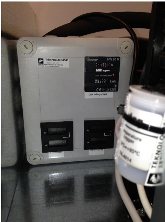
Figur 8-9 – Temperatur-logger omgivelserne (T1) og målekassen.
