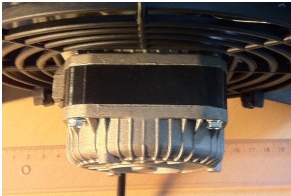
Billede 1 Originalt monteret skyggepolmotor. Set ovenfra.
