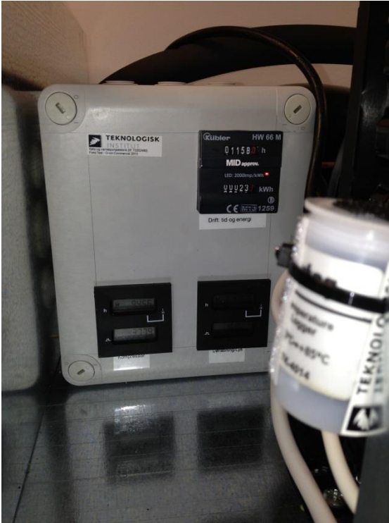
Figur 8-13 – Temperatur-logger omgivelserne (T1) og målekassen. Figur 8-14 – Temperatur-logger inde i kabinnet (T2).
