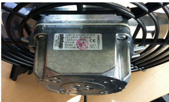
Billede 2 Eftermonteret permanent magnet motor. Set ovenfra.
