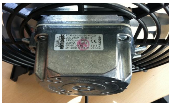
Figur 5-2: Eftermonteret permanent magnet motor. Set ovenfra.
