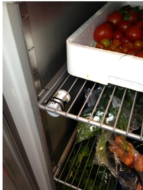
Figur 8-10 – Temperatur-logger inde i kabinnet (T2).
