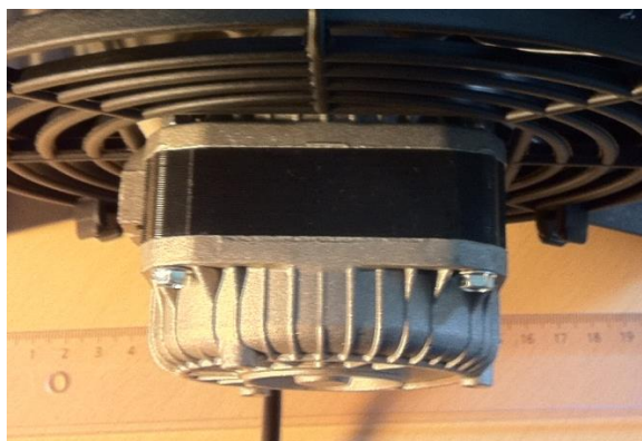
Figur 5-1: Originalt monteret skyggepolmotor. Set ovenfra.
