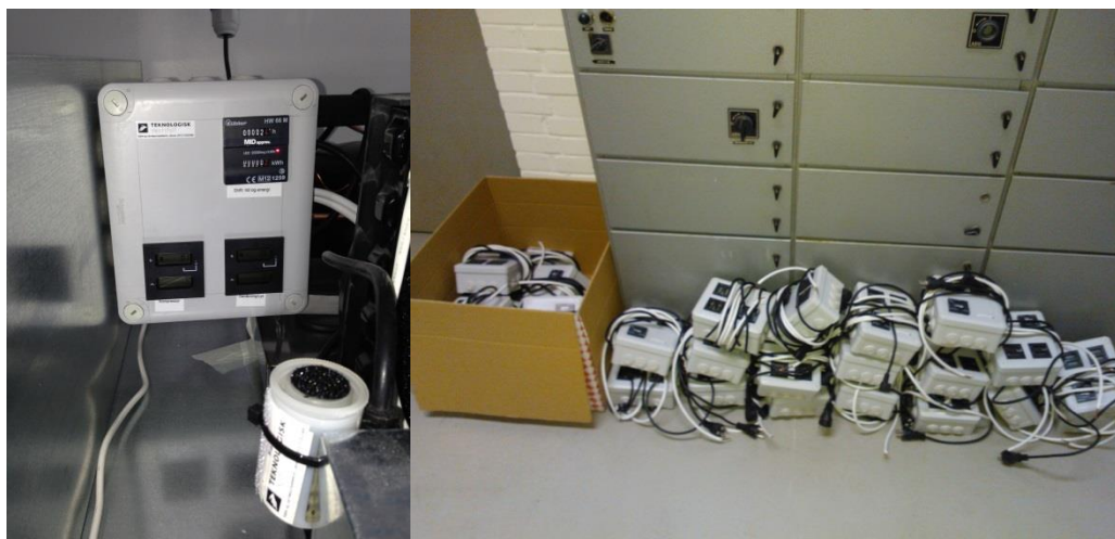
Figur 7-2: Målekasse monteret på fieldtest skab med temperaturlogger til omgivelserne monteret i forgrunden. Derudover ses de producerede målekasser inden de fremsendes til Gram Commercial for at blive monteret på test skabene.
