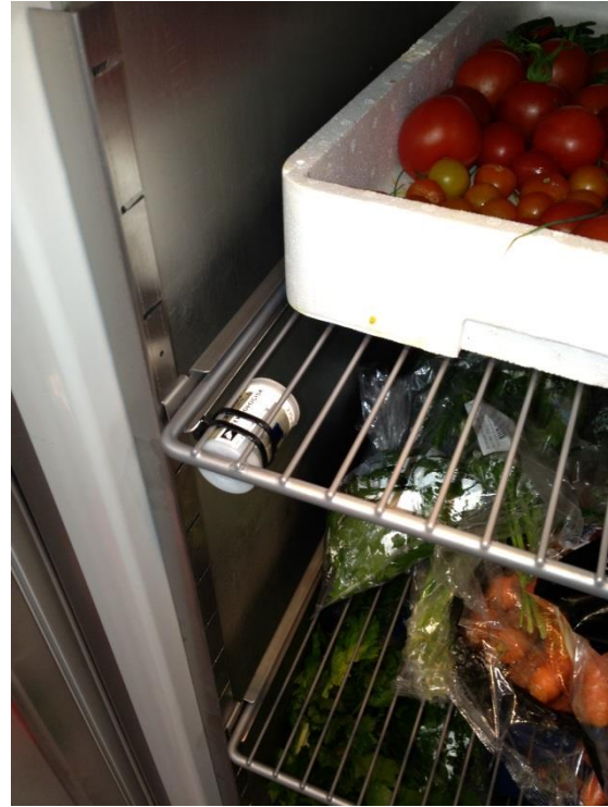
Figur 8-13 – Temperatur-logger omgivelserne (T1) og målekassen. Figur 8-14 – Temperatur-logger inde i kabinnet (T2).
