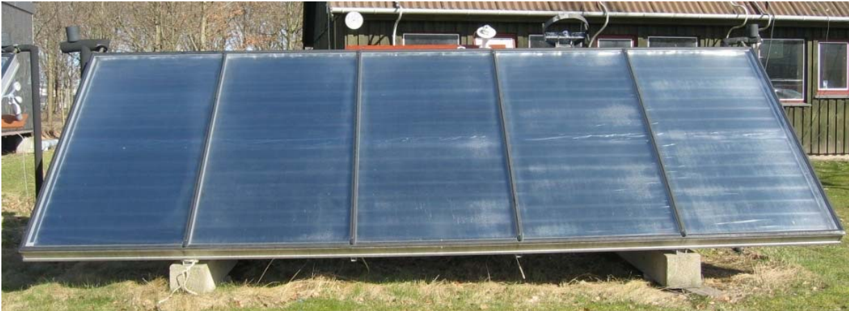
Figur 6. Solfangeren fra Marstal i DTU Bygs prøvestand.
