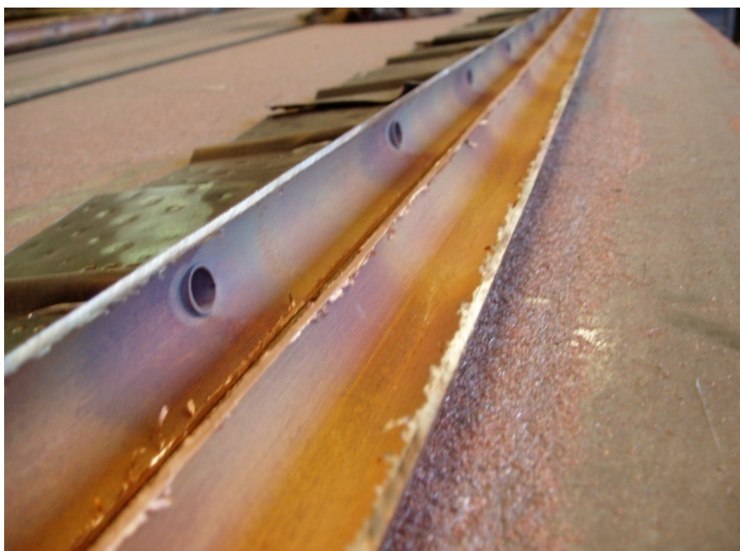
Figur 33. Udløbsmanifold for Marstal solfanger.
