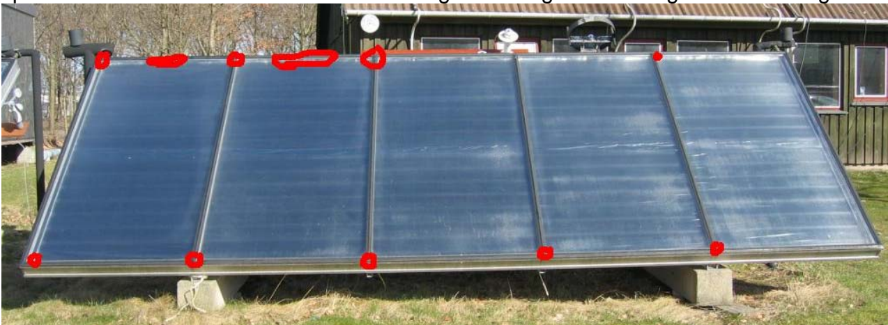
Figur 28. Sprækkeområder mærket med rødt for teflonfolien for solfangeren fra Marstal.
