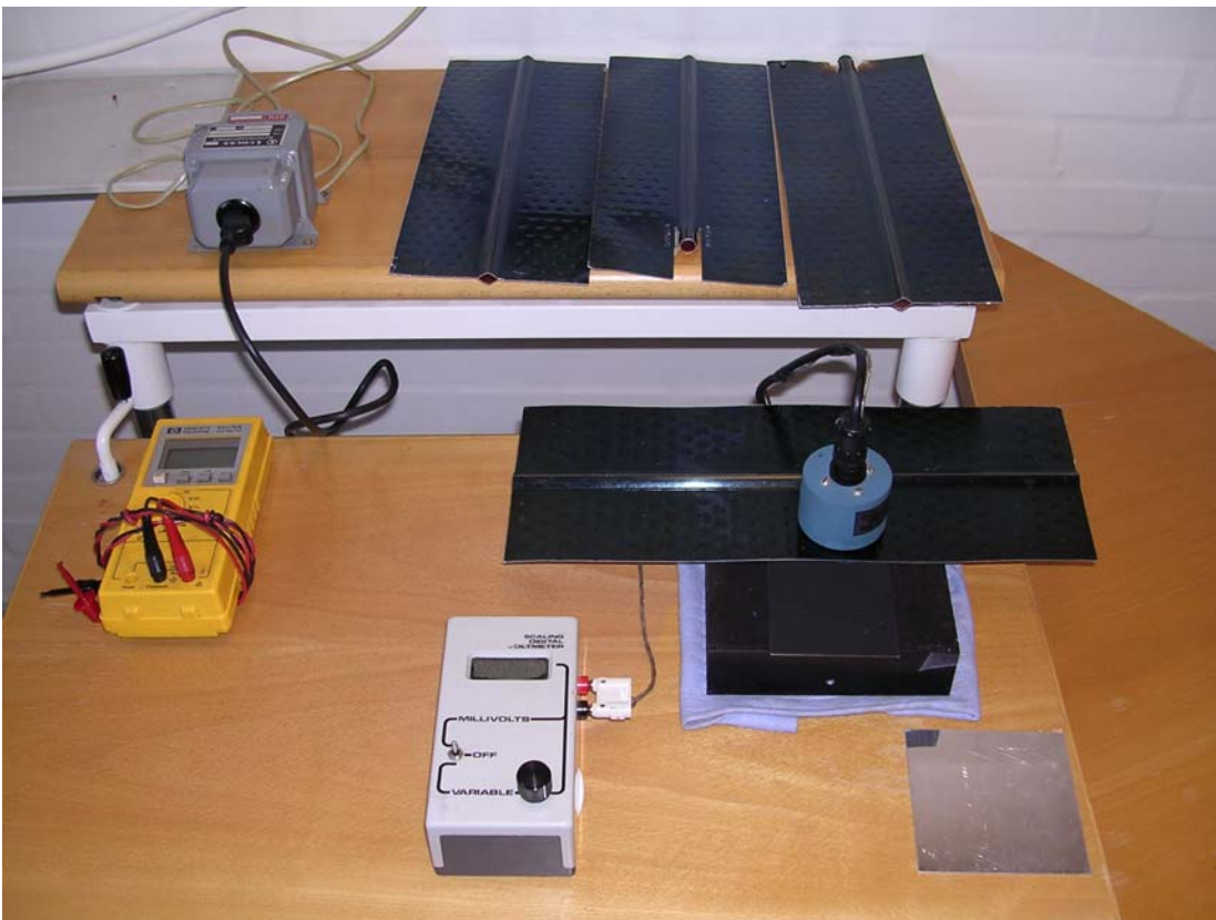
Figur 23. Forsøgsopstilling til bestemmelse af emittans for absorberstrips.
