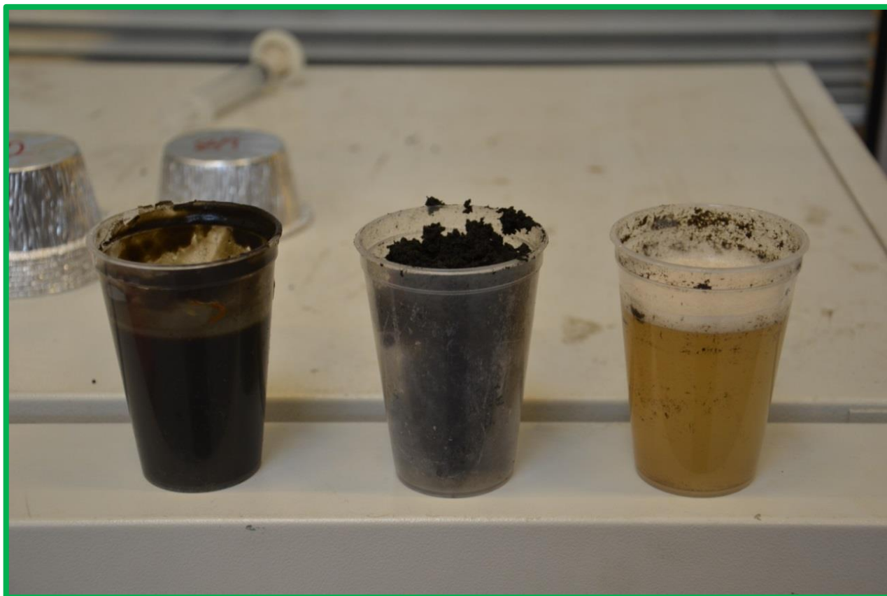
Figur 4. Tv.: Prøver af feed, slamkage og reject (vandudløb) blev efter de indledende testperioder udtaget med ½ times mellemrum. Tørstofindhold blev bestemt ved vejning før/efter tørring.
