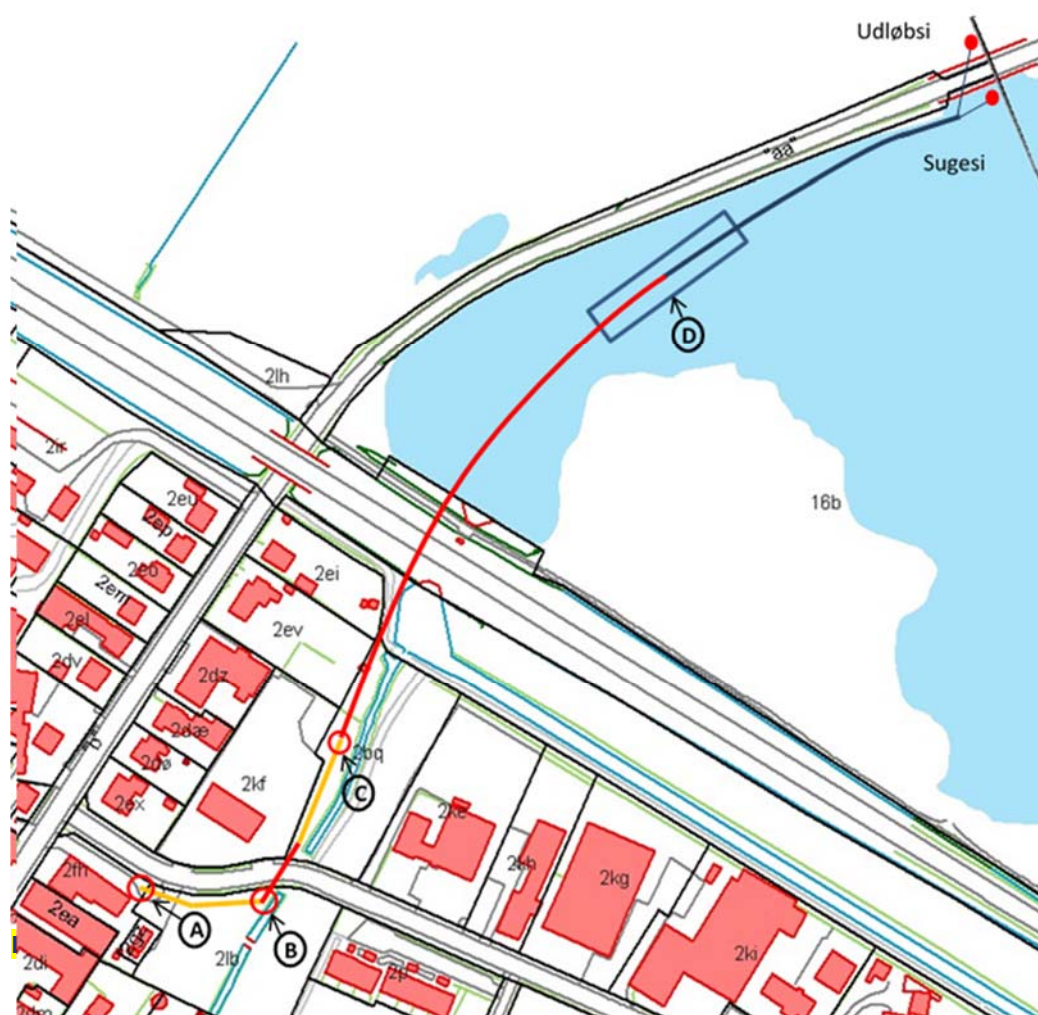
Figur B.2.3: Nedgravning og "skydning" af søvandsrør.
