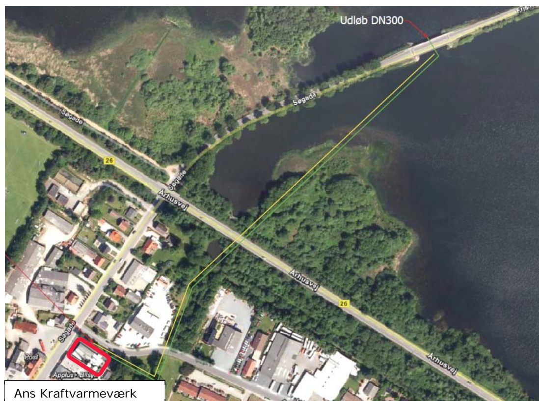
Figur 6: Planlagt rørtræk mellem Tange sø med indtag (gul) og retur (Grøn) ved broen i Søgade og Ans Kraftvarmeværk (markeret med rød ramme).
