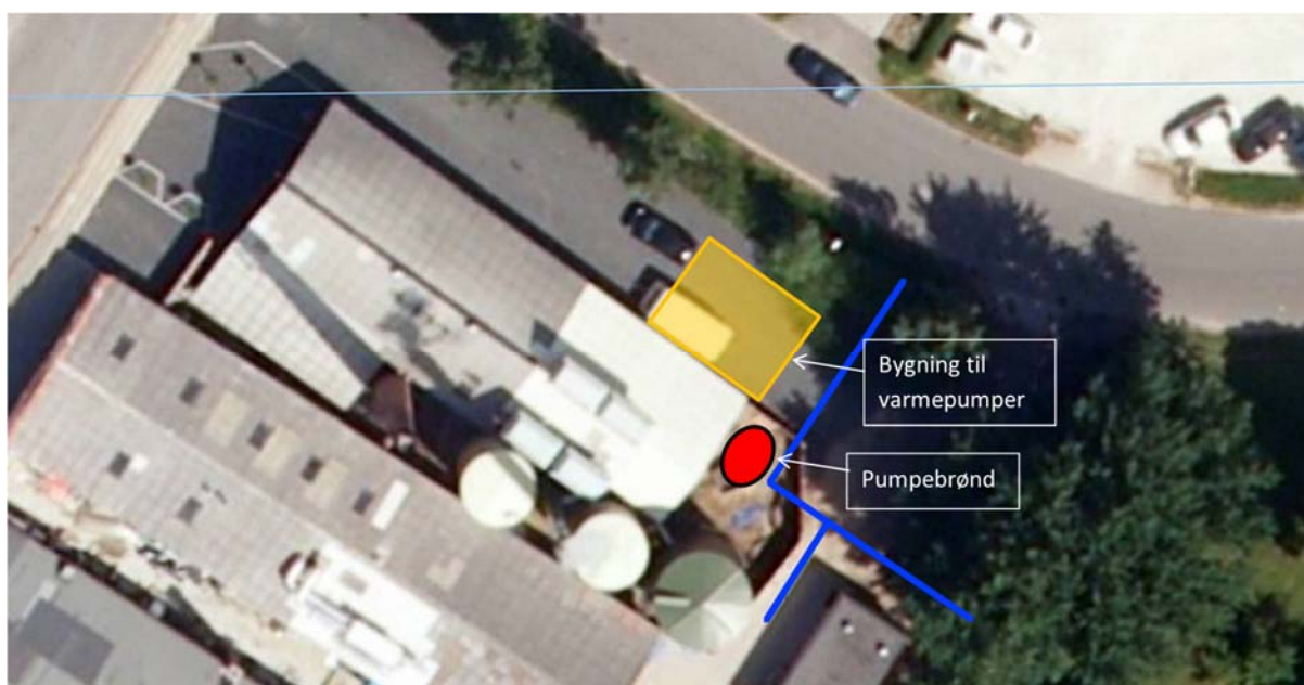
Figur 16: Placering af varmepumpesystemet inklusive pumper ved siden af AKVV's bygninger.
