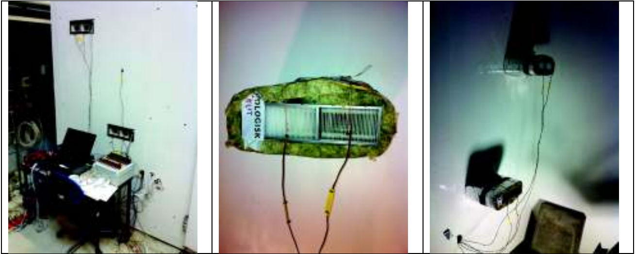
Forsøgsopstilling i frostrum og tilhørende datalogger system.
