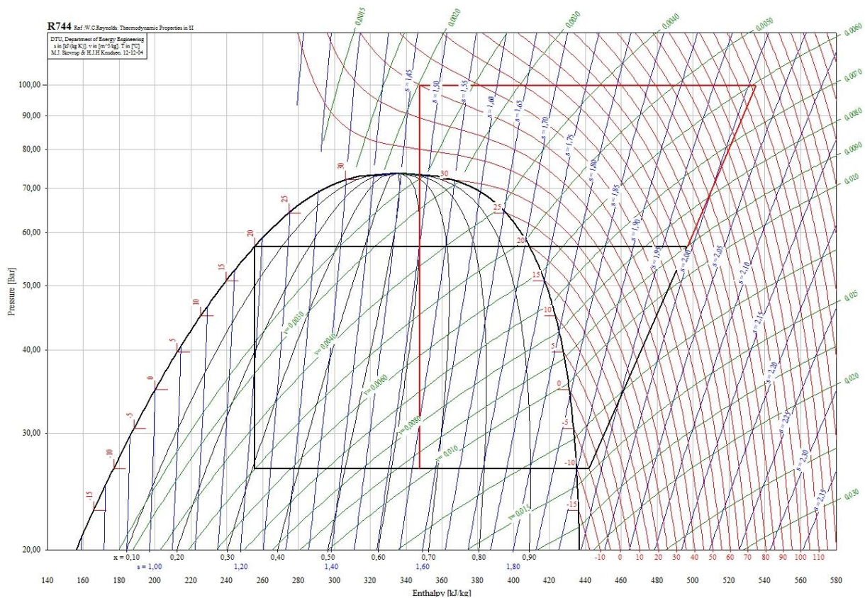
Figur 6: Sammenligning af sub- og transkritisk CO 2 proces med samme fordampningstemperatur (-10 °C)
