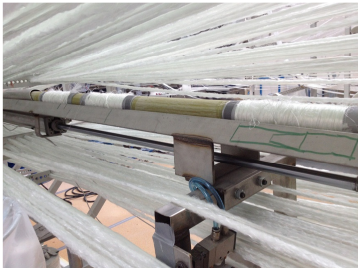
Figur 22: Indfødningsystem til pultruderingslinjen.
