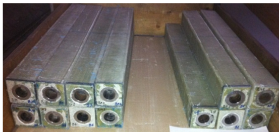
Figur 15: Bøsningstestemner klar til test.
