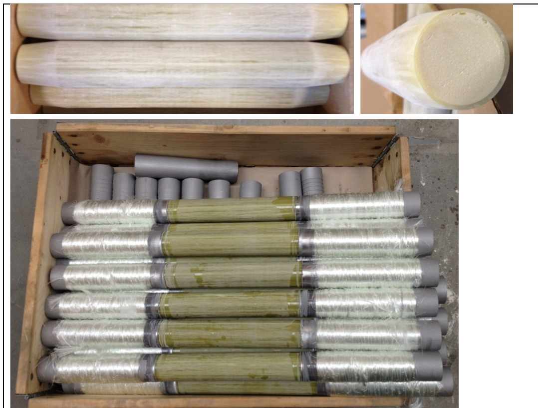
Figur 9: Bøsningskerneemner klar til pultruderingsprocessen.
